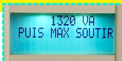
kVA = kilovoltampère. 1 kVA = 1000 VA. Dans cet exemple, Linky a enregistré une puissance maximale à 1320 VA dans la journée, tandis que 6000 VA de puissance sont autorisés.
